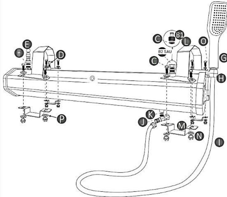
1. Installieren Sie einen Dachträger auf dem Autodach. Die Breite der Dachträgerstreben darf nicht mehr als 8–9 cm betragen. Legen Sie den Duschkörper (A) horizontal auf den Dachträger und stellen Sie sicher, dass beide Enden des Duschkörpers (A) jeweils etwa 20 cm herausragen.
